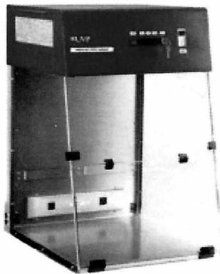
Fig. Gabinete o campana de PCR con luz ultravioleta
