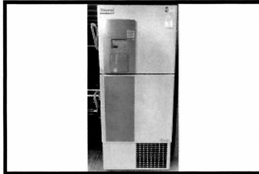
Dar un breve spin y almacenarlos en orden en cajas etiquetadas con el número de serie de muestras colocando las cajas en un refrigerador ultra a -80 °C
